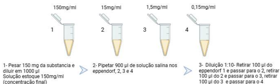
Figura 4. Preparo da solução de esterubina para obtenção das diferentes doses utilizadas para avaliação da toxicidade in vivo em larvas de Zophobas morio . Fonte: Autor, 2024.
