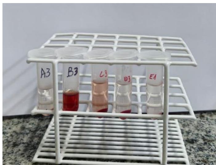
Figura 7. Visualização das amostras da solução de eritrócitos e esterubina após centrifugação no teste de hemólise in vitro .
