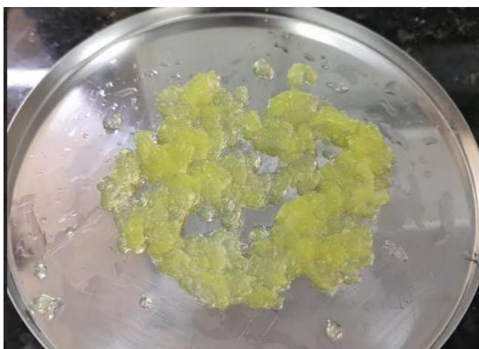
Figura 7. Hidrogel de goma de mandioca com crisina 30mg/g intumescido, após a completa absorção da crisina, sem secagem. Fonte: Autor (2025).
