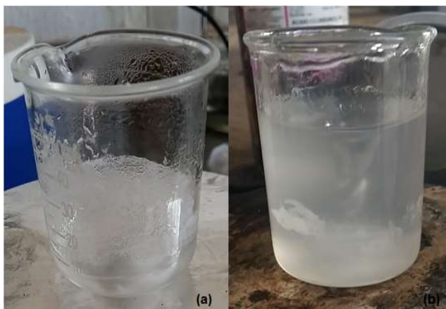
Figura 5 – Resina melamina-formaldeído: (a) pura. (b) dissolvida em etanol
