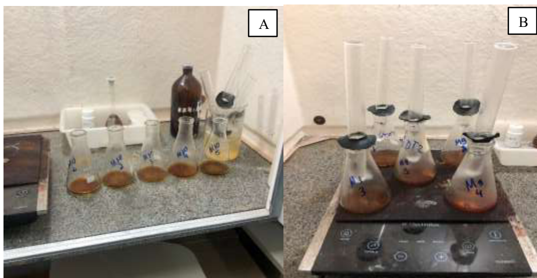
Figura 4. A e B: Aquecimento da análise de oxidação úmida com dicromato de potássio ( K_2Cr_2O_7 ) para identificação de COT.
