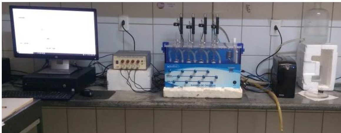
Figura 11: Sistema in vitro utilizado. Transdutor de tensão acoplado a uma amplificador de sinal
