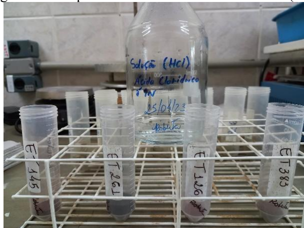
Figura 19 - Etapa de acréscimo do ácido clorídrico (HCl)
