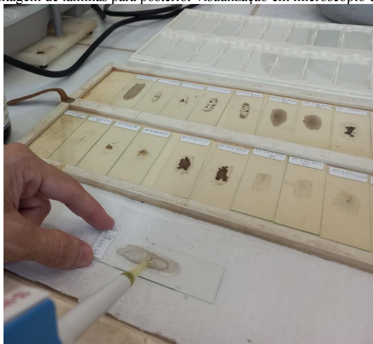
Figura 29 - Montagem de lâminas para posterior visualização em microscópio de luz transmitida
