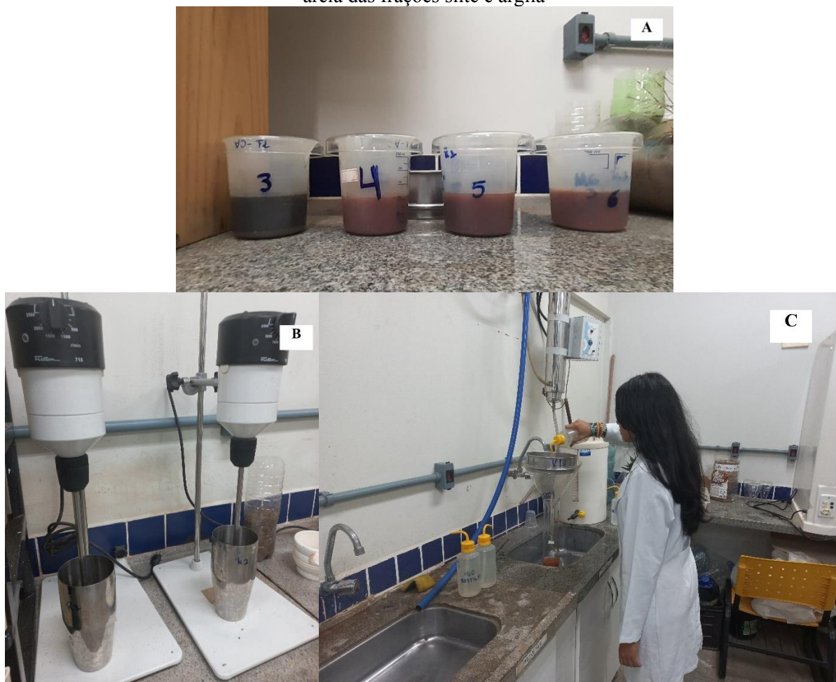
Figura 11 - A: Sedimento com hidróxido de sódio. B: Uso do agitador elétrico. C: Separação da fração areia das frações silte e argila
