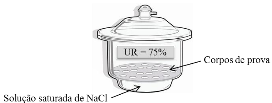
Figura 18 – Ilustração do sistema utilizado nos ensaios de absorção de umidade
