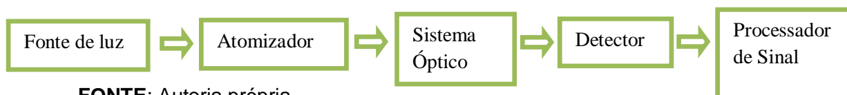
Esquema 1 – Instrumentação básica da técnica de absorção atômica
