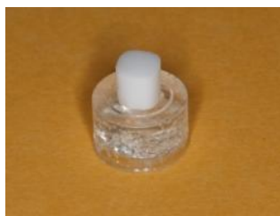
Figura 1. Cilindro de zircônia colado no centro do disco de resina acrílica incolor.
