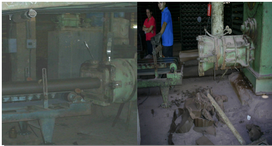
Figura 9 – Maromba: fabricação da telha da atividade cerâmica
