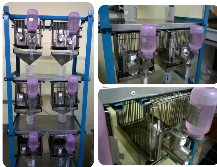
Figura 23: Equipamento de monitorização do consumo de água e ração e dos parâmetros fisiológicos dos animais em estudo.
