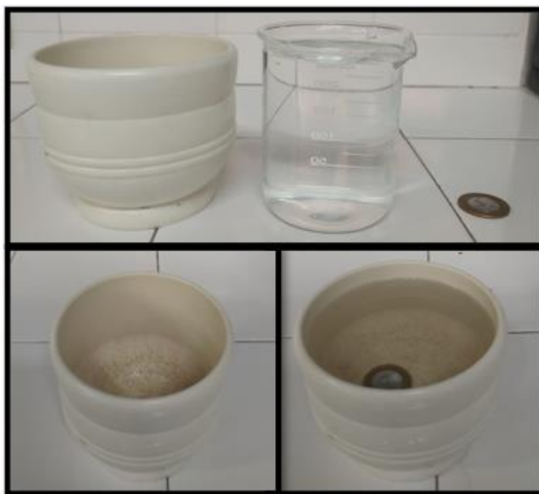
Figura 24 – Experimento de refração da luz, utilizando recipiente opaco, um béquer com água e uma moeda.
