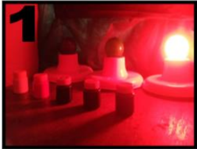
Figura 20 - Momento 1: luz vermelha: absorvida nas tintas verde, azul e preta e refletidas nas tintas branca e vermelha.
