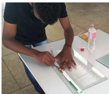
Figura 06. Corte do vidro transparente
