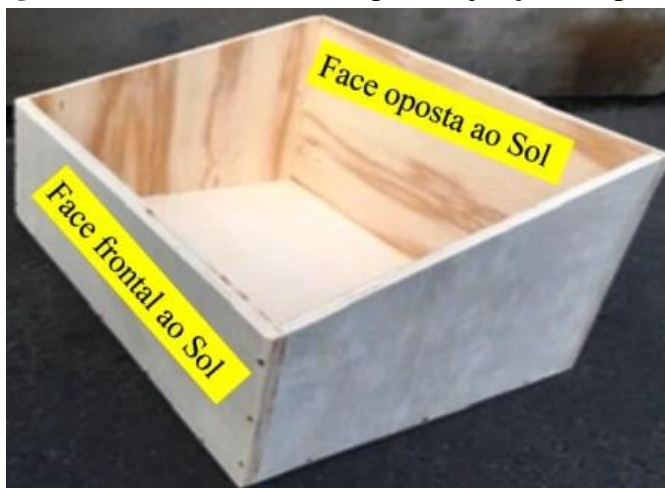
Figura 10. Caixa do forno depois da junção das partes.
