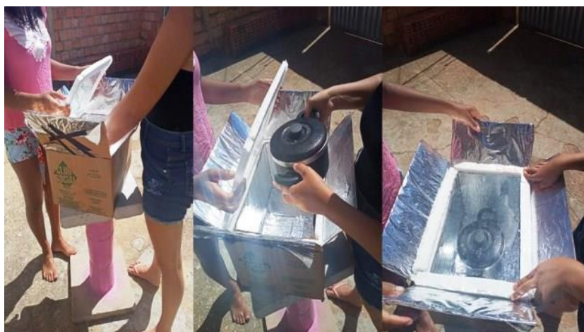
Figura 18. Primeiros testes do forno solar.
