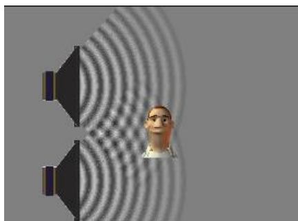
Figura 22: Interferência de duas ondas sonoras
