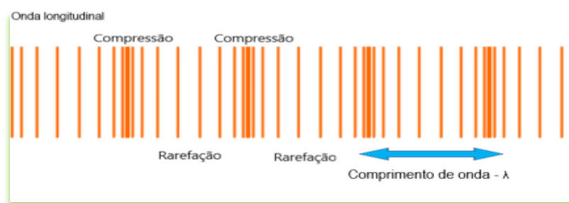
Figura 16: propagação de uma onda sonora
