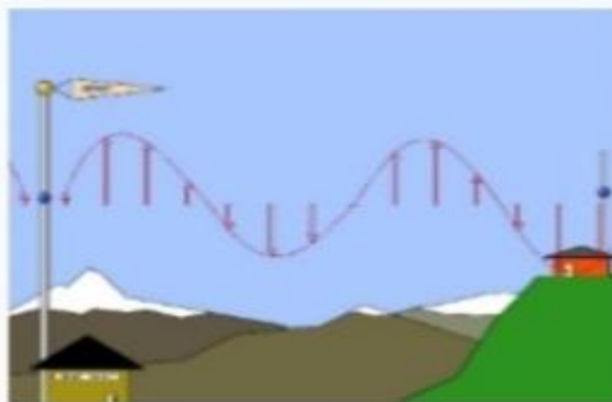
Figura 2: Propagação das ondas eletromagnéticas em uma estação de rádio
