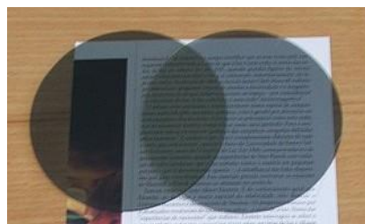
Figura 11: Polarização da luz
