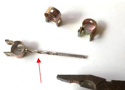
Foto 60 – Furo com broca de 3,2 mm
