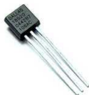
Foto 14: Sensor DS18B20 encapsulamento TO-92
