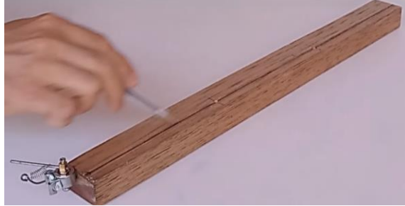
Foto 119 – Marcação da posição do tubo na base
