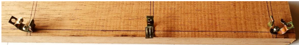
Foto 64 – Fixando as abraçadeiras na base
