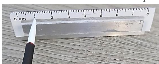
Foto 104 – Marca milimétrica na altura do ponteiro
