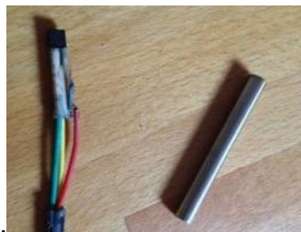
Foto 16: Encapsulamento metálico do sensor DS18B20 à prova d'água
