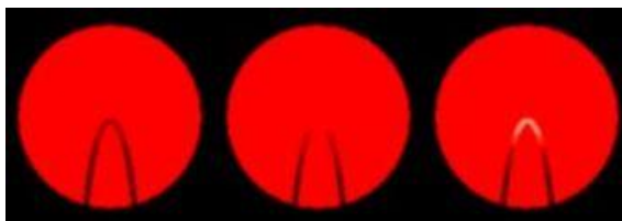
Foto 5: Comparação visual num pirômetro de filamento que desaparece
