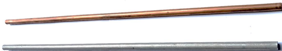
Foto 11 – Tubo de cobre e alumínio
