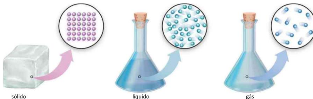
Figura 1.1 Representação (sem escala e em cores fantasia) da agitação das partículas que formam os sólidos, os líquidos e os gases.
