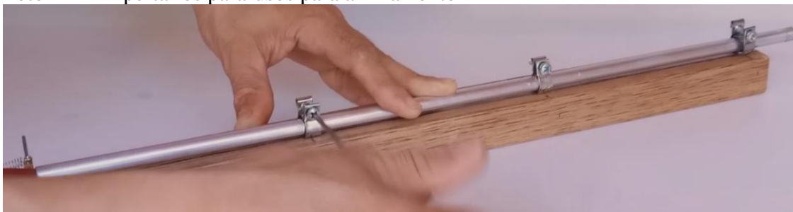
Foto 122 – Apertar os parafusos para alinhamento
