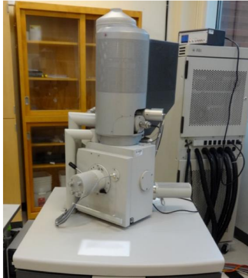
Figura 15- Microscópio eletrônico scanner modelo Nova NanoSEM 200
