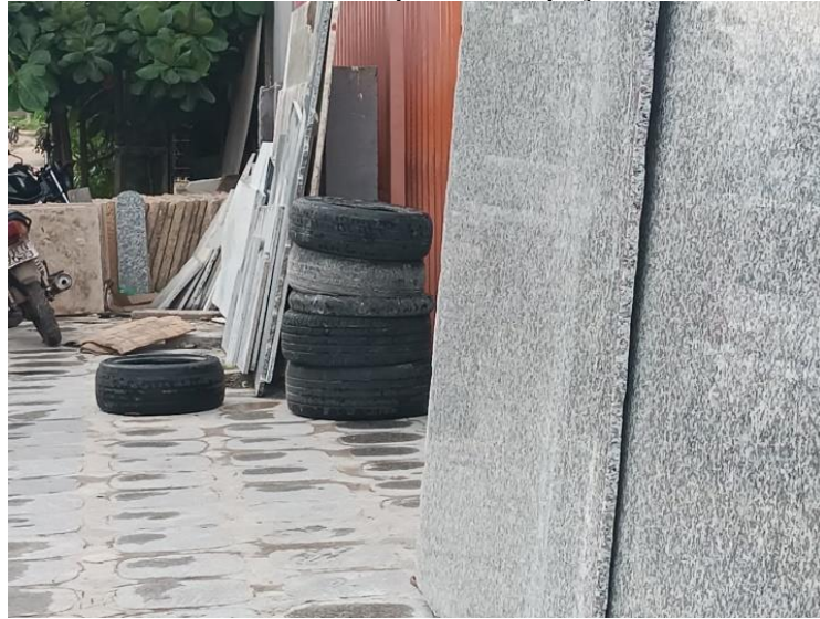
Figura 17 – Pneus utilizados nos transportes das peças na marmoraria N
