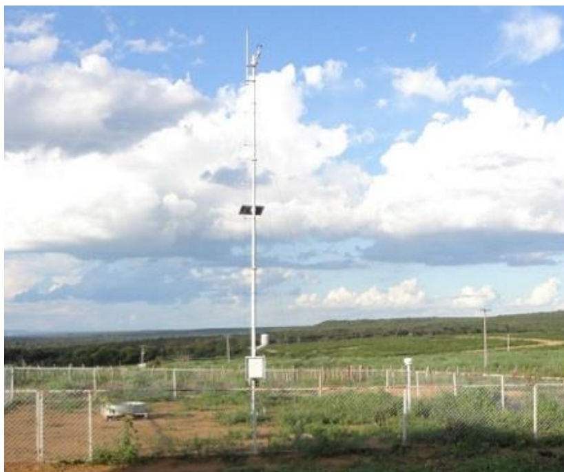
Figura 4. Estação agrometeorologia automática do INMET instalada no Campus Professora Cinobelina Elvas – UFPI, Bom Jesus, PI. (Fonte: SIMEÃO).
