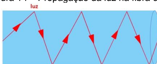
Figura 14 – Propagação da luz na fibra ótica.
