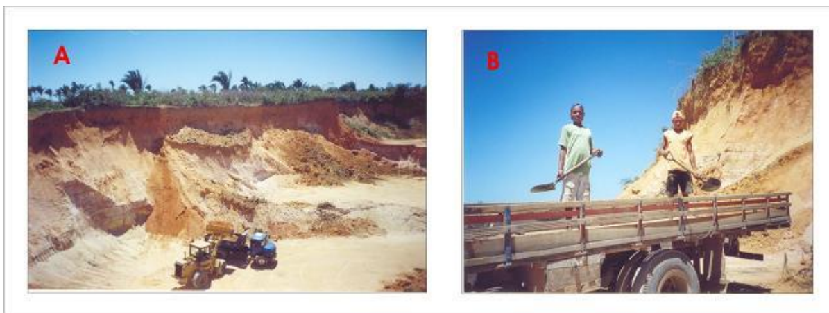
Figura 37 – Meios de transportes, de carregamento e descarregamento de “massará”. A: Caminhão caçamba e pá carregadeira; B: Caminhão com carroceria de madeira e pá. Fonte: A autora (2006).
