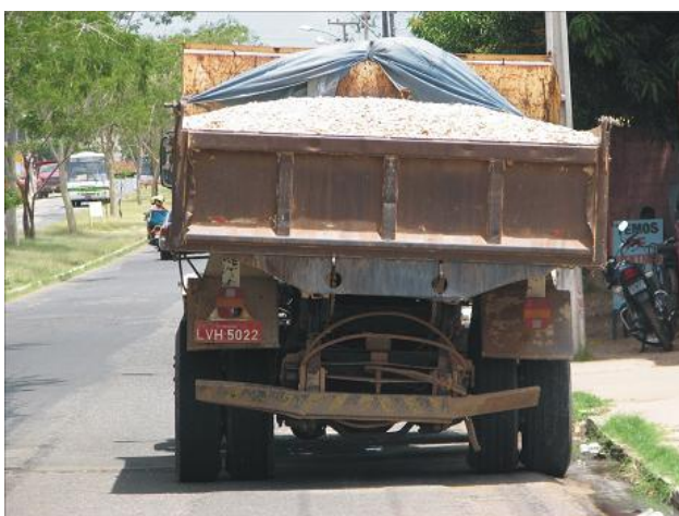
Figura 59 – Caminhão transportando material de construção sem uso da lona para proteção da carga.
