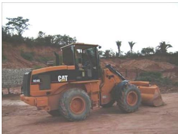
Figura 57 – Pá carregadeira utilizada na extração de massará. Fonte: A autora (2007).
