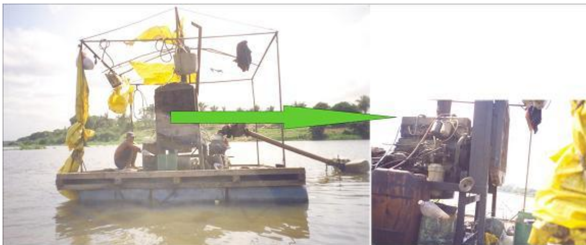
Figura 56 – Draga instalada no rio Poti na Zona Norte de Teresina. Em destaque, condições do motor da draga.
