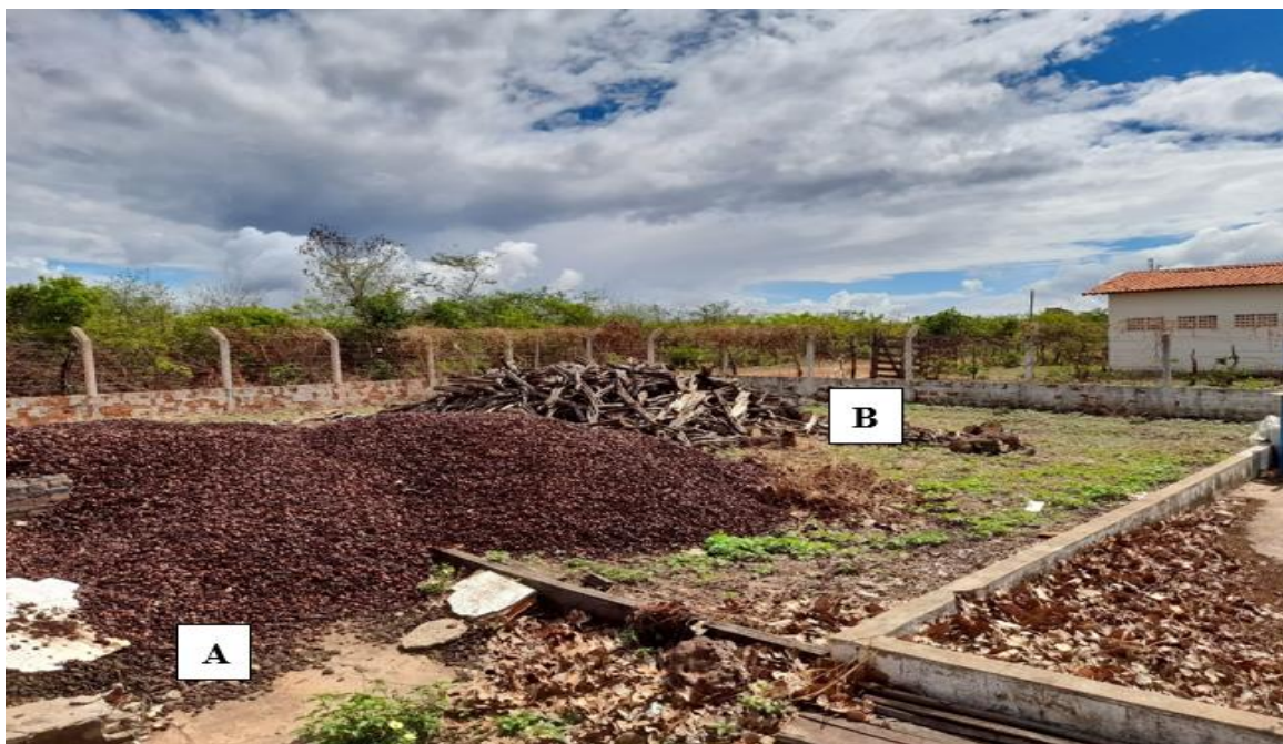
Fotografia 5 – Armazenamento da casca (A) e madeira (B) utilizados na caldeira de cozimento nas minifábricas de amêndoas
