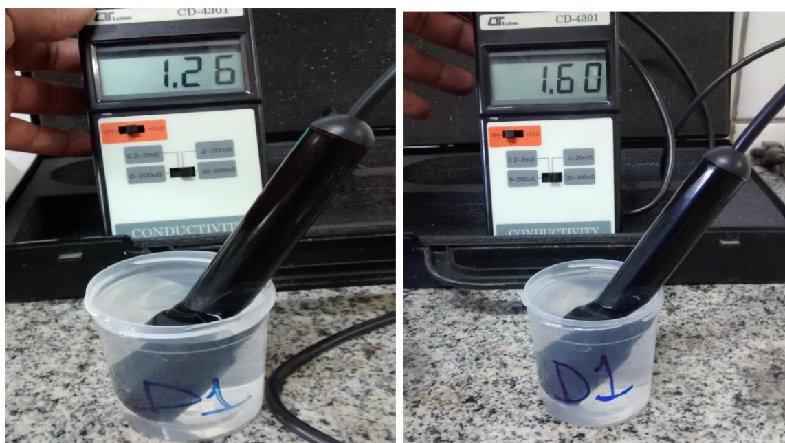
Figura 3. Leitura da condutividade elétrica em condutímetro, modelo Lutron CD-4301. Teresina, PI, 2016.
