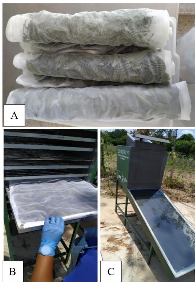
**Figura 3:** Processo de desidratação de folhas e caules de ora-pro-nóbis. A: folhas e caules separados; B: folhas sendo colocadas no aparelho de desidratação solar; C: desidratador solar termo fotovoltaico Ecodrytec (Modelo 216GII) . Fonte: Arquivo pessoal.
