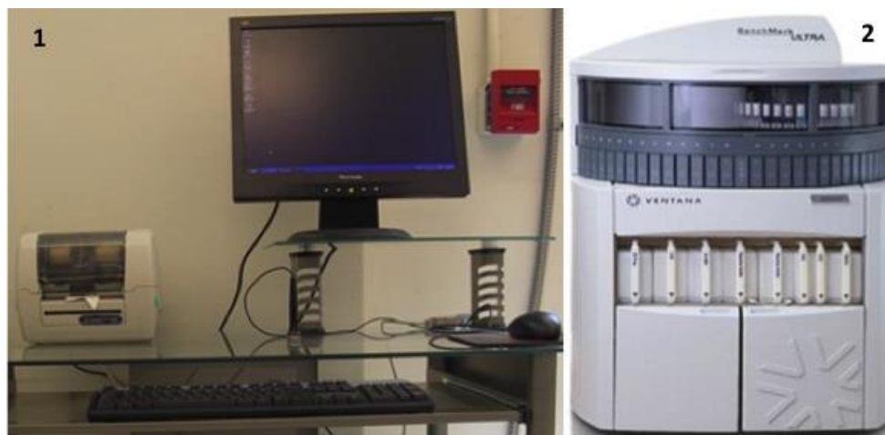
Figura 5- Sistema computadorizado BenchMark Ultra (Ventana Medical Systems®). 1 computador com software de controle; 2: Instrumento de coloração das lâminas.
