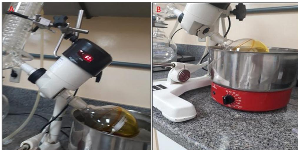
**Figura 5.** Fotografia do processo de separação do etanol e os extratos brutos pelo uso do rotaevaporador.
