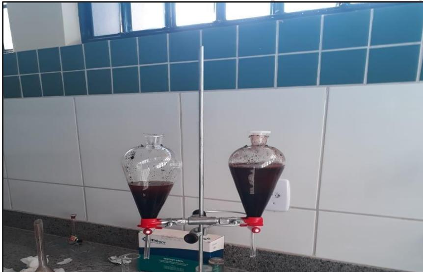
**Figura 4.** Fotografia dos Funis de decantação com a mistura de cada pó com etanol 96%. **Legenda:** Seta vermelha indica mistura entre o etanol e pó do cajá; a seta amarela indica mistura entre etanol e pó do pequi.
