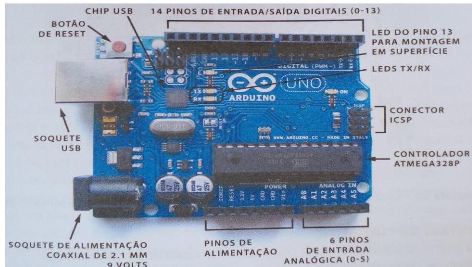
Figura 15 - Subdivisão do hardware do Arduino
