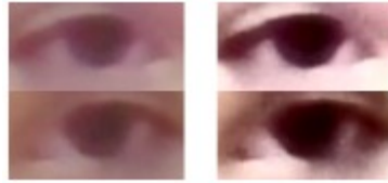
Figura 6 – Imagem escura à esquerda e a imagem com o processamento da equalização do histograma à direita.
