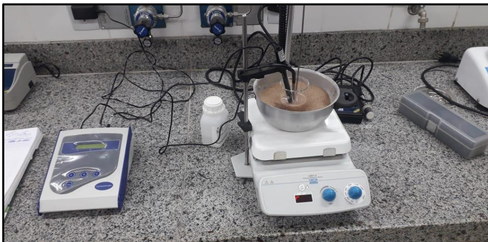
Figura 5 - Ensaio de condutividade elétrica pelo método de Lúxan et al. (1989).
