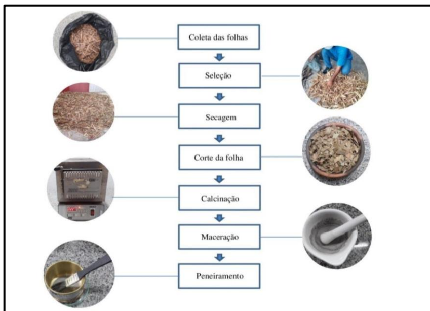
Figura 4 - Etapas na produção das cinzas de folha de bambu (CFB).
