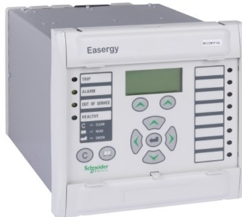
Figura 15 – Relé comercial utilizado nos testes do relé protótipo (P142 da Schneider Electric)
