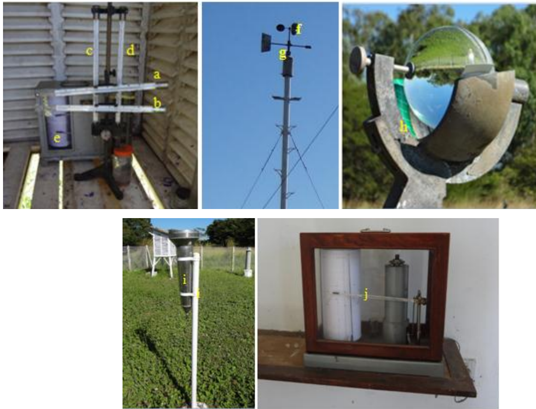
Figura 3. Sensores meteorológicos presentes nas estações meteorológicas convencionais: termômetro de máxima (A), termômetro de mínima (B), termômetro de bulbo seco (C), termômetro de bulbo úmido (D), termohigrógrafo (E), sensor de velocidade (F) e direção do vento (G), heliógrafo (H), pluviômetro (I) e barógrafo (J).
