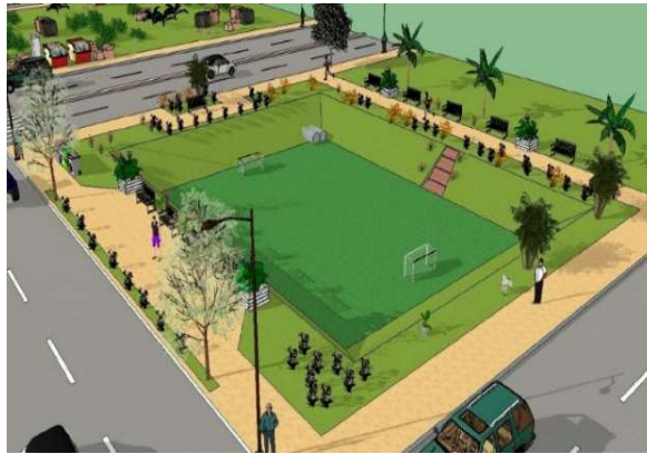
Figura 5 – Reservatório de detenção à céu aberto: (a) funcionando como área de lazer, (b) funcionando como dispositivo hidráulico de detenção.
