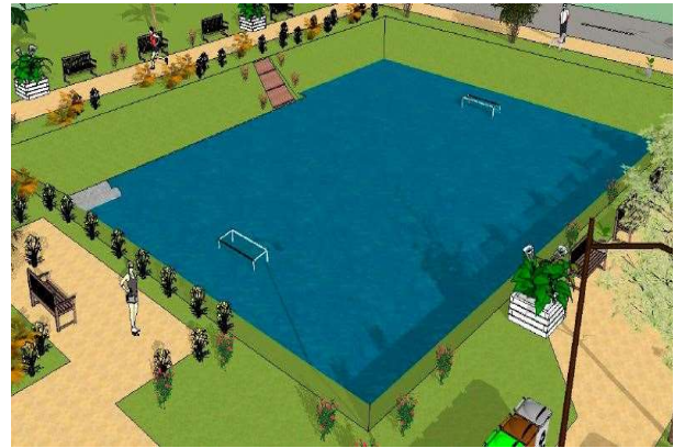
Figura 5 – Reservatório de detenção à céu aberto: (a) funcionando como área de lazer, (b) funcionando como dispositivo hidráulico de detenção.
