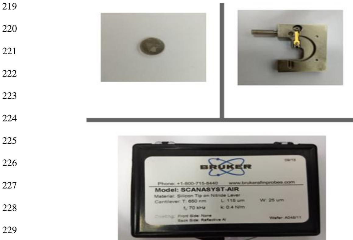
230 *Figura 2. Sondas de microscopia de força atômica modelo Scanasyst Air..*
