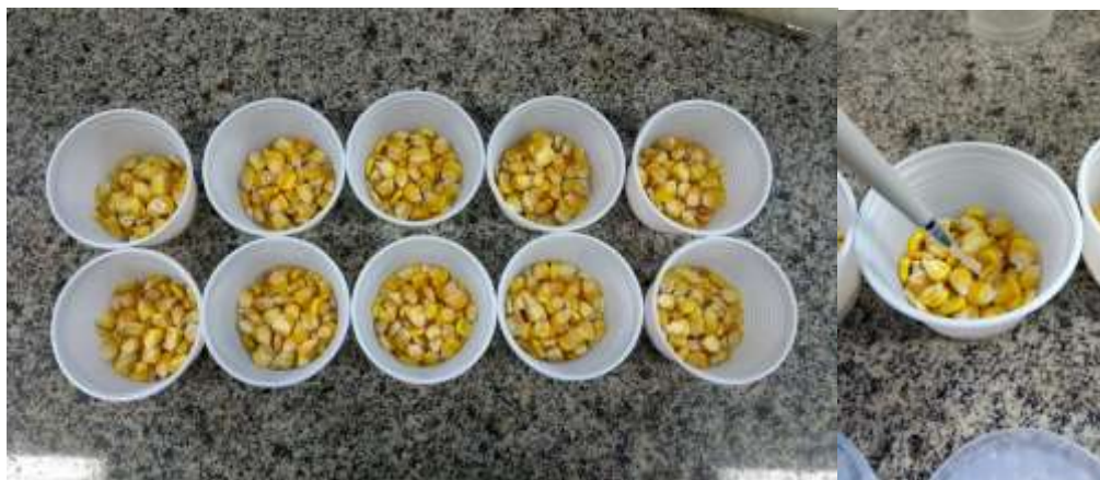
Figura 2 Esquema da impregnação dos óleos nas sementes (teste de contato) de milho com auxílio de micropipetador automático.
