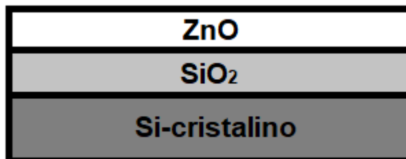
Figura 10: Esquema de deposição conceitual dos filmes utilizado para o ajuste teórico das medidas experimentais de elipsometria.
