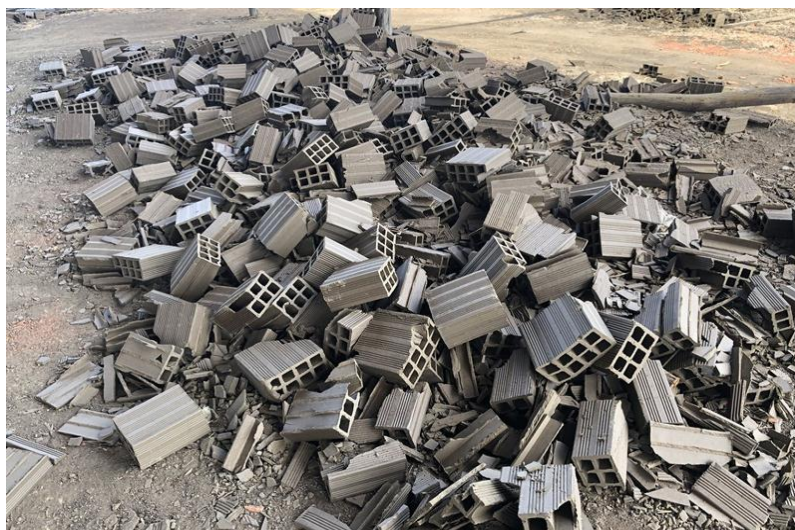
Figura 6: Material cru não conforme.
