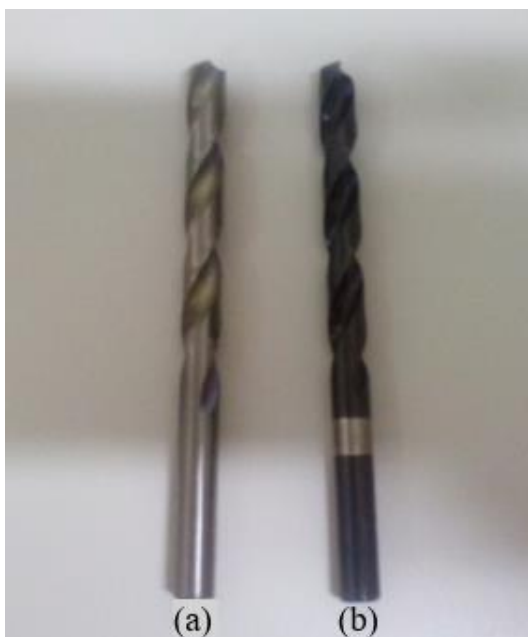
Figura 14 – Brocas de aço rápido: (a) sem revestimento; (b) com revestimento
