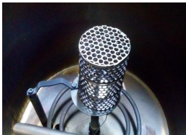
Figura 17 – Montagem do arranjo para deposição com gaiola catódica.
