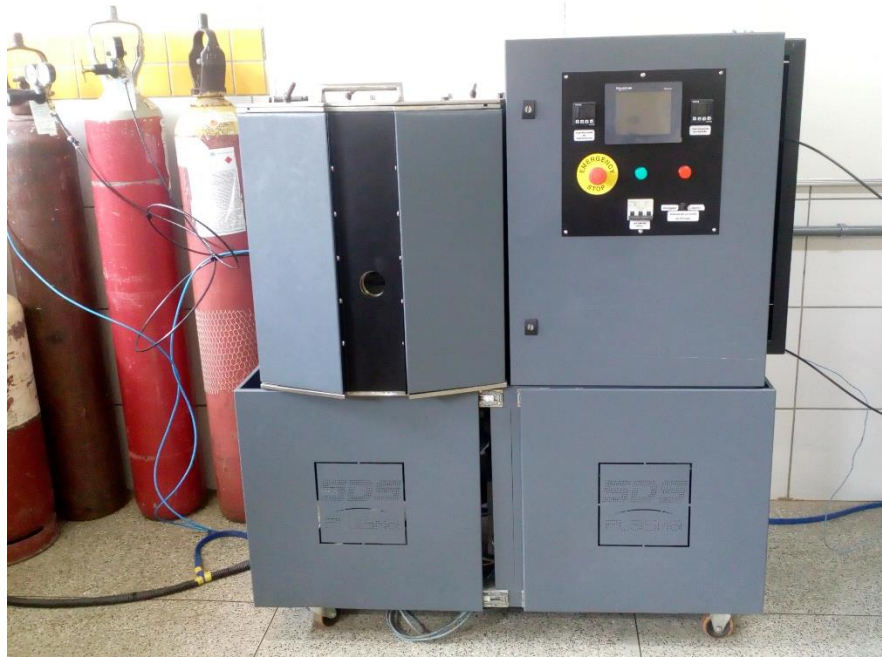
Figura 15 – Imagem do reator de nitretação a plasma do LabPlasma – UFPI.
