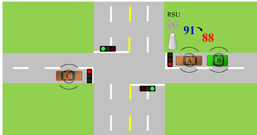
Figura 6 – Mecanismo de controle do semáforo decrementando o tempo da fase após a chegada de novos veículos. Figura retirada de (HSIEH; TSAI, 2013).
