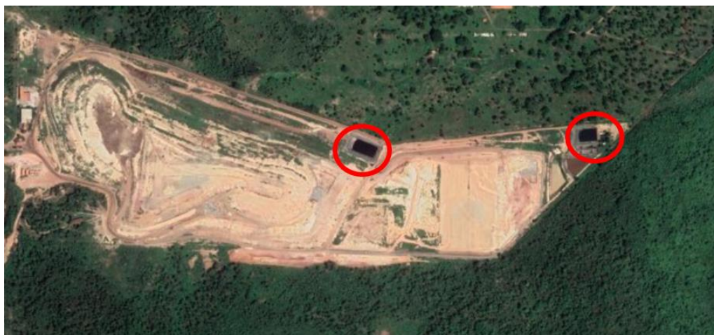
Figura 6: Vista área do aterro sanitário de Teresina – PI (42°44'40.63"O ) em destaque a lagoa de chorume.
