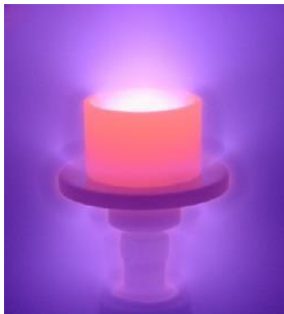
Figura 4. Efeito de cátodo oco em um cilindro.
