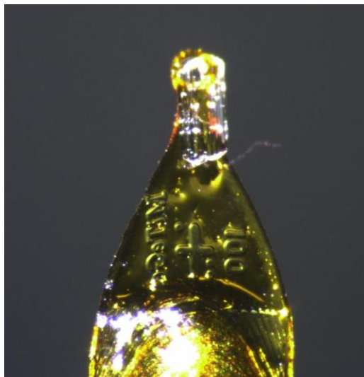
Figura 9: Monocristal utilizado no experimento de difração de raios-X.
