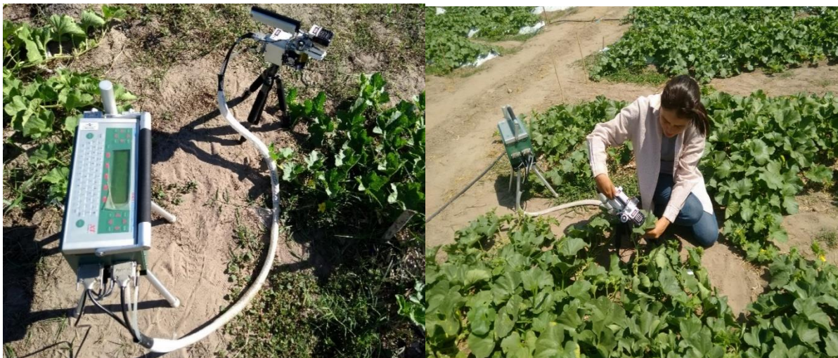
Figura 7 Detalhe do Analisador portátil de fotossíntese por radiação infra-vermelha – IRGA, durante o monitoramento das trocas gasosas no meloeiro. Teresina, PI. 2017-2018.
