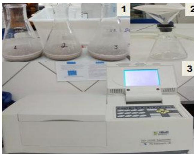
Figura 12. (1) Diluição das amostras em triplicata; (2) Filtração à vácuo; (3) Espectrofotômetro.
