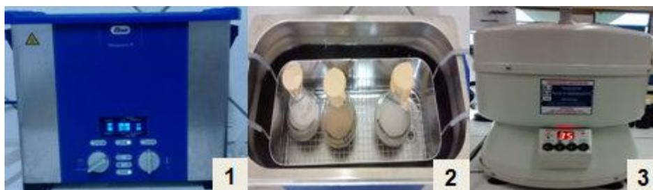
Figura 14. (1) Equipamento de ultrasson; (2) Interior do equipamento de ultrasson com os três extratos; (3) Centrífuga. Fonte: Autoria própria, 2015.
