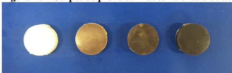
Figura 16 – Corpos de prova utilizados no ensaio de absorção acústica
