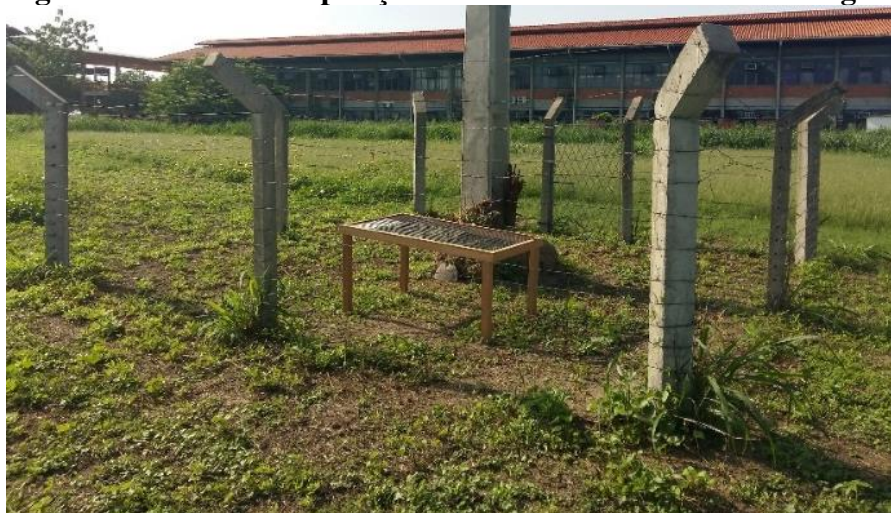
Figura 19 – Rack de exposição das amostras submetidas à Degradação abiótica
