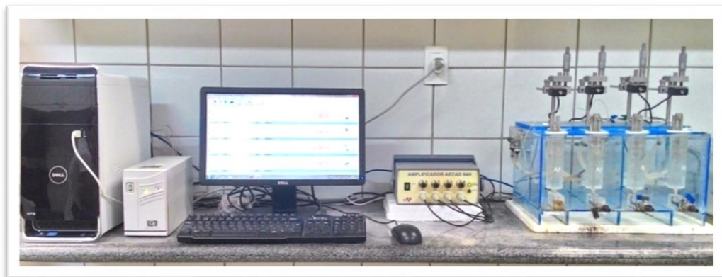
Figura 25: Sistemas de cubas para órgãos isolados e de aquisição de dados do NPPM/UFPI (AECAD 1604, AQCAD 2.0.5., AVS Projetos, SP).
