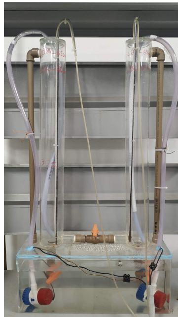
Figura 25 – Sistema de tanques de nível acoplados utilizado na pesquisa.
