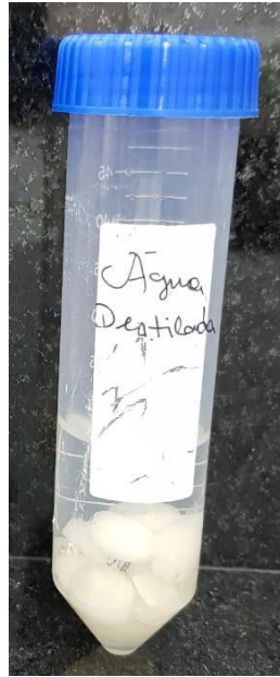
Figura 1. Corpos de prova imersos em água destilada.
