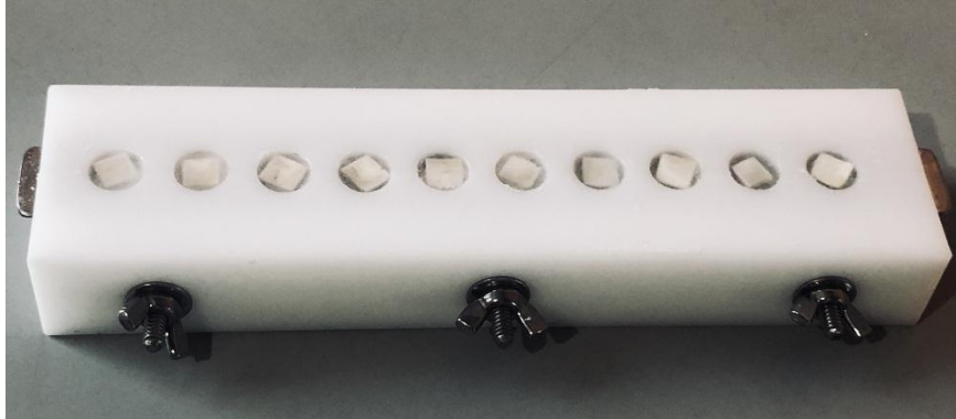
Figura 3. Matriz de teflon com blocos de dentes posicionados e incluídos em resina acrílica autopolimerizável incolor, durante o processo de polimerização.
