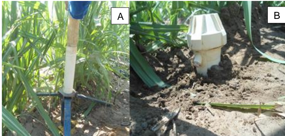
Figura 4 Colocação do tubo de acesso para monitoramento da água no solo (A) e instalação completa com vista da parte externa do tubo (B). Embrapa Meio-Norte, Teresina, Piauí.
