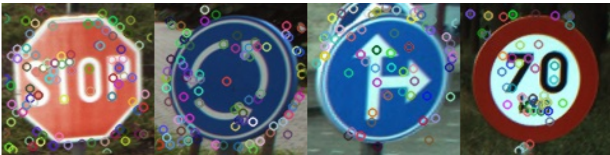
Figura 11 – Exemplos de pontos de interesses detectados pelo SIFT em imagens de placas de trânsito. Fonte: Elaborado pelo Autor.
