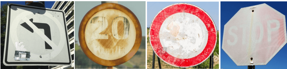
(c) Exemplos de placas de trânsito desgastadas pela ação do tempo.
