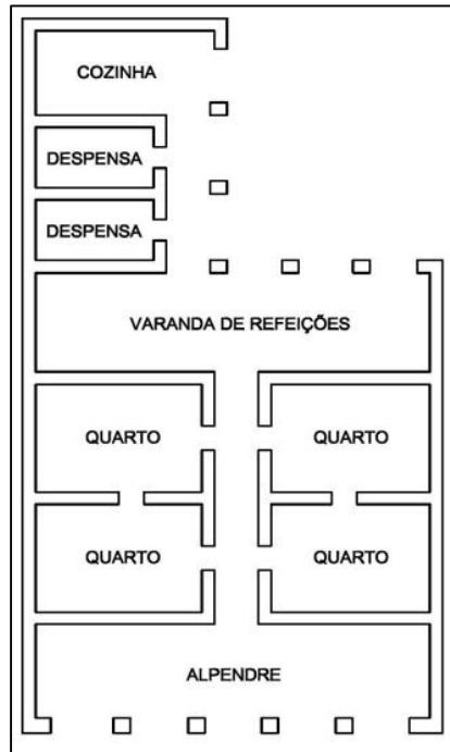
Figura 2: Planta baixa esquemática de uma fazenda piauiense, demonstrando a localização da varanda de refeições. Fonte: BRITO, 2011.
