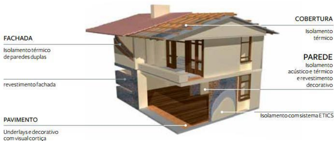
Figura 6 Esquema exemplificativo da aplicação de cortiça em uma construção
